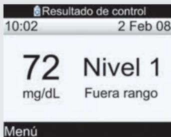
Si el resultado del control del funcionamiento está fuera del rango aceptable, en la pantalla detallada Resultado de control aparece “Fuera rango”.
