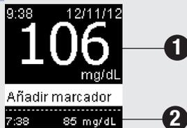
El resultado de glucemia aparece en la parte superior de la pantalla ①. Si la función **Último resultado** está activada, aparece el resultado anterior en la parte inferior de la pantalla ②. Consulte los detalles de la función **Último resultado** en el capítulo **Ajustes del medidor**.
