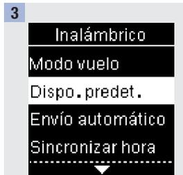
Pulse **▲** o **▼** para resaltar **Dispo. predet.**. Pulse **OK**. Aparece una lista de dispositivos sincronizados.
