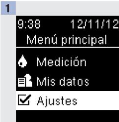
Pulse brevemente **OK** para encender el medidor. En el **Menú principal**, pulse **OK** para resaltar **Ajustes**. Pulse **OK**.
