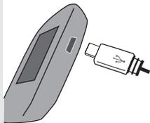
Enchufe el extremo pequeño del cable USB en el medidor.
