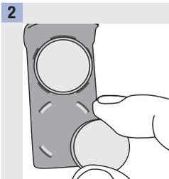
Saque las pilas usadas y coloque las nuevas en el compartimento de las pilas con **el lado del símbolo (+) hacia abajo**.
