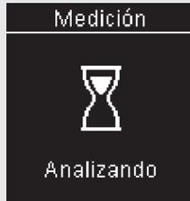
Aparece **Analizando** cuando hay suficiente solución de control en la tira reactiva.
