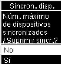
Si ya hay 5 dispositivos sincronizados, aparece **Sincron. disp.**. Debe eliminar un dispositivo sincronizado antes de proceder al paso 5. Seleccione **Sí**. Pulse **▶** o **▼** para resaltar el dispositivo a eliminar. Pulse **OK**. Vaya al paso 5.
