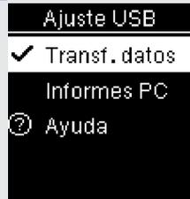
Pulse **▶** o **◀** para resaltar **Transf. datos** o **Informes PC**. Pulse **OK** para desplazar **✓** hasta la opción. Pulse **OK** para guardar la opción y volver a **Ajustes**.
