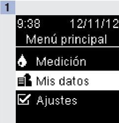
Pulse brevemente **OK** para encender el medidor. En el **Menú principal**, pulse **▲** o **▼** para resaltar **Mis datos**. Pulse **OK**.
