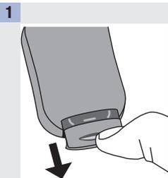
Utilice el pulgar para deslizar el compartimento de las pilas y sacarlo del medidor.
