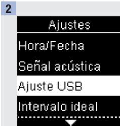
Pulse **▲** o **▼** para resaltar **Ajuste USB**. Pulse **OK**.
