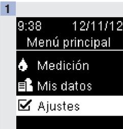
Pulse brevemente **OK** para encender el medidor. En el **Menú principal**, pulse **▼** para resaltar **Ajustes**. Pulse **OK**.
