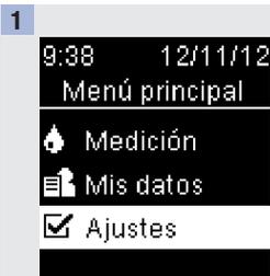
Pulse brevemente **OK** para encender el medidor. En el **Menú principal**, pulse **▼** para resaltar **Ajustes**. Pulse **OK**.
